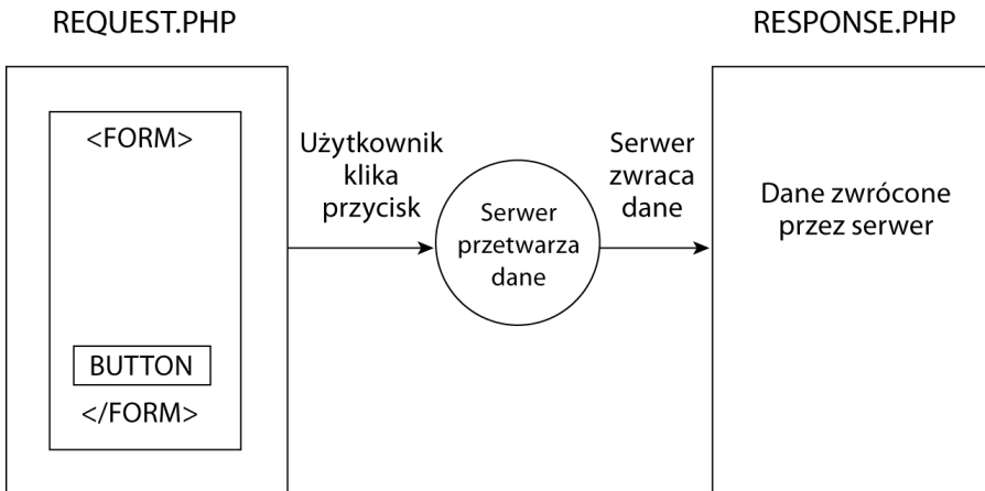
Rysunek 3.1. Klasyczny model przesyłania formularzy w PHP oraz ASP
