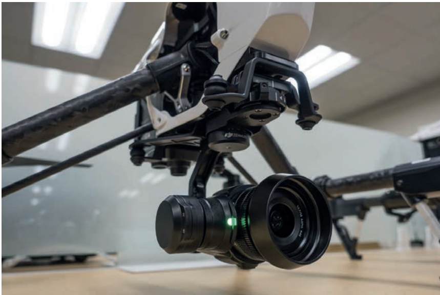
RYСУNEK 4.12. Nowy gimbal DJI Zenmuse X5 i kamera Mikro Cztery Trzecie (prototyp z obiektywem 15 mm) wprowadza wymienną optykę i średniej wielkości matryce do zintegrowanych fotodronów
