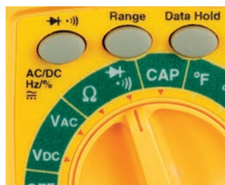
Rysunek 2.32. Aby sprawdzić, czy nie ma przerwy w obwodzie, ustaw pokrętkę swojego miernika na symbol pokazany na zdjęciu. Używaj tego ustawienia wyłącznie, kiedy mierzony komponent lub obwód nie jest zasilany
