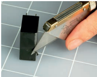
Rysunek 2.52. Aby zajrzeć do zabezpieczonego przekaźnika, przycinaj krawędzie przekaźnika do momentu, kiedy uzyskasz minimalną wolną przestrzeń
