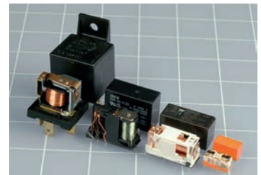
Rysunek 2.57. Cztery przekaźniki różnego typu zasilane napięciem 12 V, pokazane w swojej obudowie i bez niej. Przekaznik stosowany w samochodach (skrajnie lewy) jest najprostszy i najłatwiejszy do zrozumienia, ponieważ przy jego projektowaniu rozmiar obudowy nie miał szczególnego znaczenia. Mniejsze przekaźniki są zaprojektowane bardziej pomysłowo, ich konstrukcja jest bardziej złożona i trudniejsza do rozpracowania. Mniejsze przekaźniki są przeważnie przeznaczone do przełączania mniejszych prądów niż ich większe odpowiedniki
