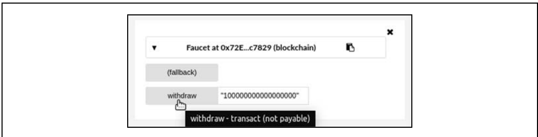
Rysunek 2.21. Kliknij przycisk withdraw w środowisku Remix, aby utworzyć transakcję wycofywania środków
