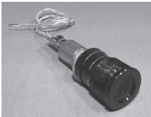
RYСУNEK 10.20. Obiektyw rozpraszający wiązkę przymocowany do modułu laserowego
