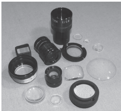
RYСУNEK 10.19. Różne obiektywy wyjęte ze starych kamer
