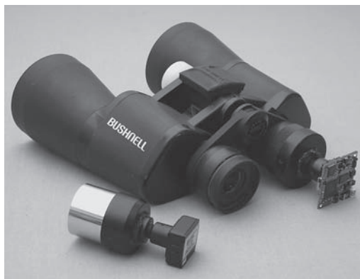
RYСУNEK 10.22. Pokrywka na wizjer lornetki dobrze nadaje się do zamocowania kamery
