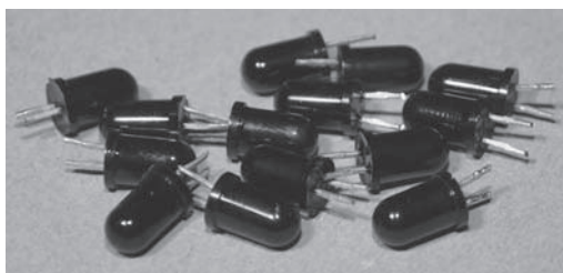
RYСУNEK 10.29. Diody LED z końcówkami przyciętymi na minimalną długość
