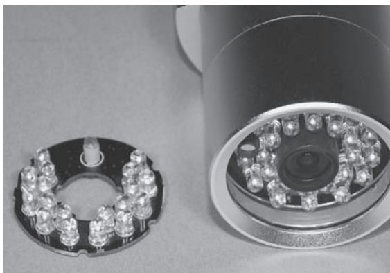
RYСУNEK 10.13. Alternatywne rozwiązanie dla pojedynczej diody LED
