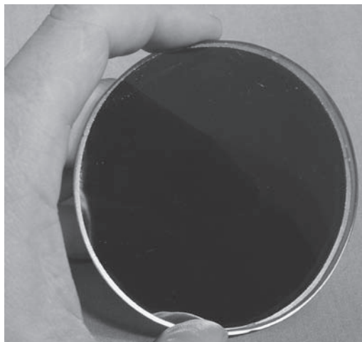
RYСУNEK 10.14. Szklany filtr przepuszczający promieniowanie podczerwone o długości fali 940 nm
