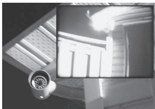
RYСУNEK 10.40. Zastosowanie noktowizora do wykrywania kamer bezpieczeństwa
