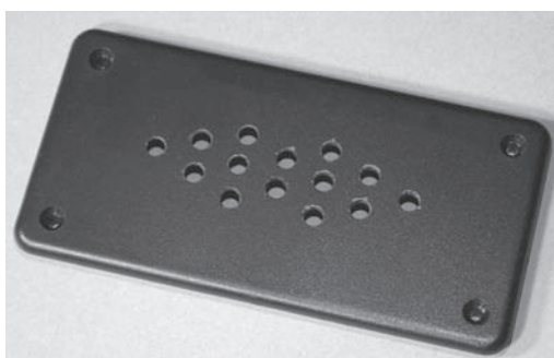
RYСУNEK 10.28. Wywiercone otwory na diody LED
