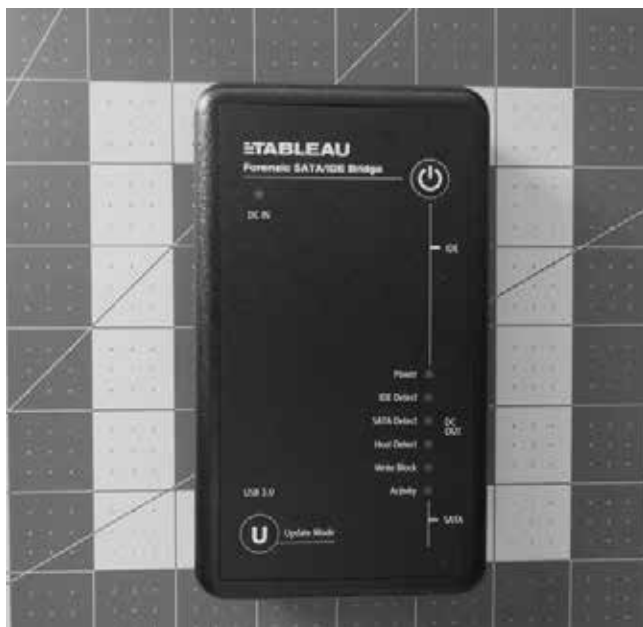
Rysunek 3.7. Fizyczna blokada zapisu
