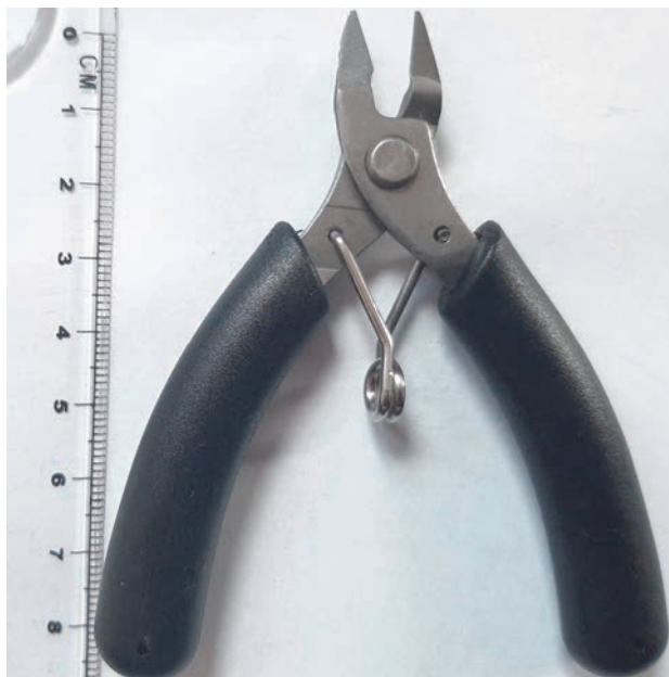
Rysunek 1.6. Cienkie zakończenia ułatwiają precyzyjne operowanie narzędziem
