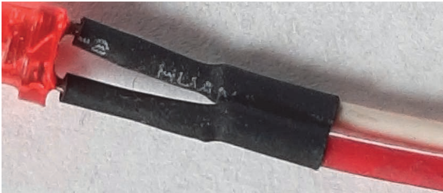
Rysunek 1.14. Połączenie zaizolowane z wykorzystaniem koszulek termokurczliwych
