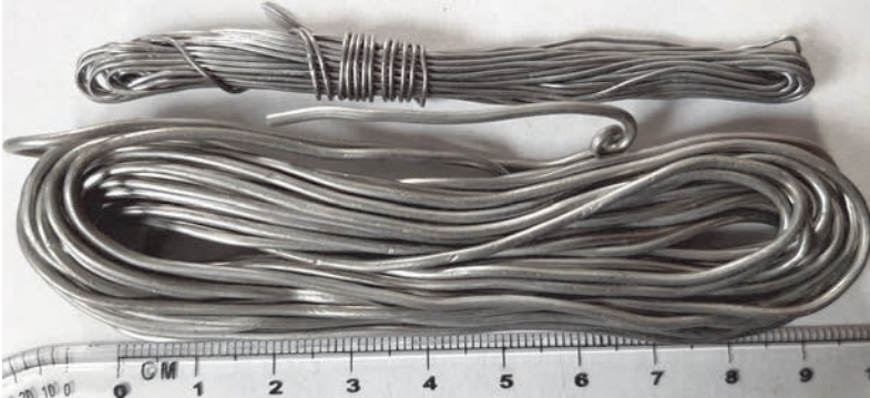
Rysunek 1.12. Cienkie lutowie lepiej sprawdzi się przy montażu układów elektronicznych. Z grubszego będzie wygodniej korzystać podczas lutowania instalacji CO i CW
