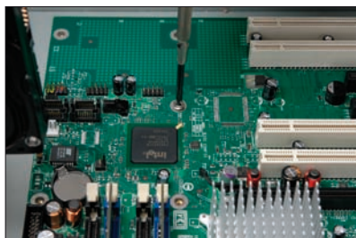
Rysunek 4.33. Montaż płyty głównej w obudowie — etap trzeci
