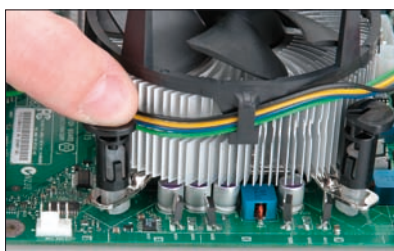
Rysunek 4.23. Montaż radiatora na procesorze Intel w wersji LGA 775 — etap trzeci
