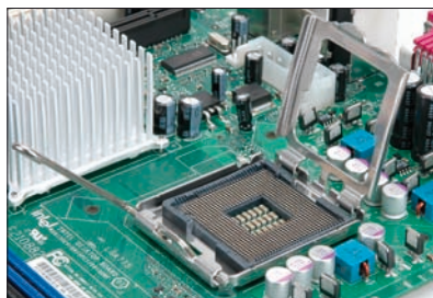
Rysunek 4.5. Otwieranie podstawki LGA 775 — kolejny etap
