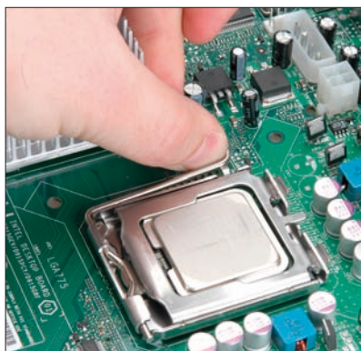
Rysunek 4.14. Montaż procesora Intel LGA 775 — etap trzeci
