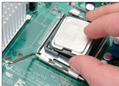
Rysunek 4.12. Montaż procesora Intel LGA 775 — etap pierwszy
