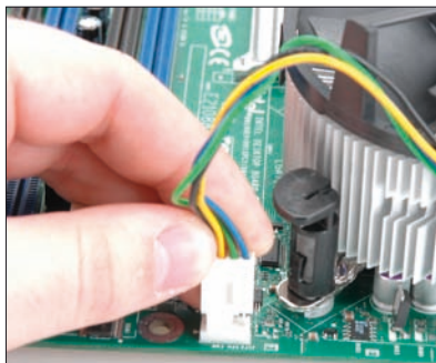
Rysunek 4.26. Nie zapomnij podłączyć zasilania wentylatora
