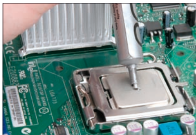
Rysunek 4.16. Powierzchnię procesora należy pokryć cienką warstwą pasty
