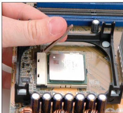
Rysunek 4.10. Montaż procesora AMD lub Intel Socket 478 — etap drugi
