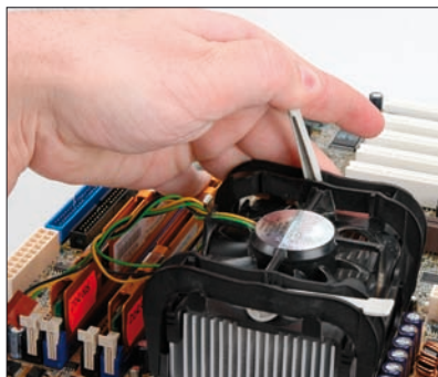
Rysunek 4.20. Montaż radiatora na procesorze Intel w wersji Socket 478 — etap czwarty. Zapnij plastikowe dźwignie — najpierw z jednej, a później z drugiej strony. Wymaga to użycia siły
