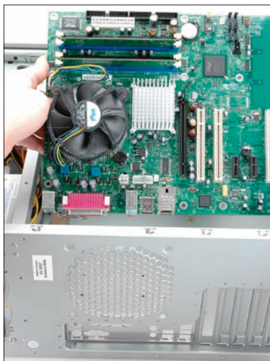
Rysunek 4.31. Montaż płyty głównej w obudowie — etap pierwszy
