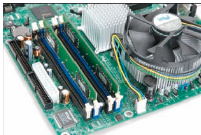
Rysunek 4.30. Montaż pamięci w gnieździe — etap trzeci
