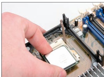
Rysunek 4.9. Montaż procesora AMD lub Intel Socket 478 — etap pierwszy
