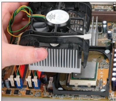
Rysunek 4.17. Montaż radiatora na procesorze Intel w wersji Socket 478 — etap pierwszy
