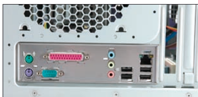
Rysunek 4.32. Montaż płyty głównej w obudowie — etap drugi
