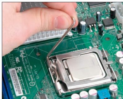
Rysunek 4.13. Montaż procesora Intel LGA 775 — etap drugi
