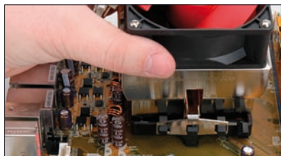
Rysunek 4.24. Montaż radiatora na procesorze AMD — etap pierwszy
