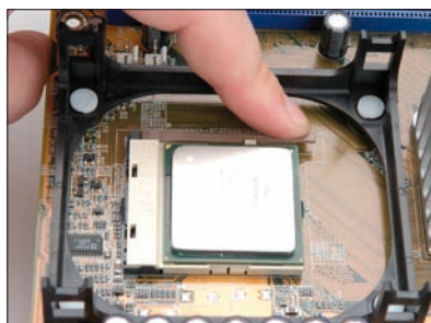
Rysunek 4.11. Montaż procesora AMD lub Intel Socket 478 — etap trzeci
