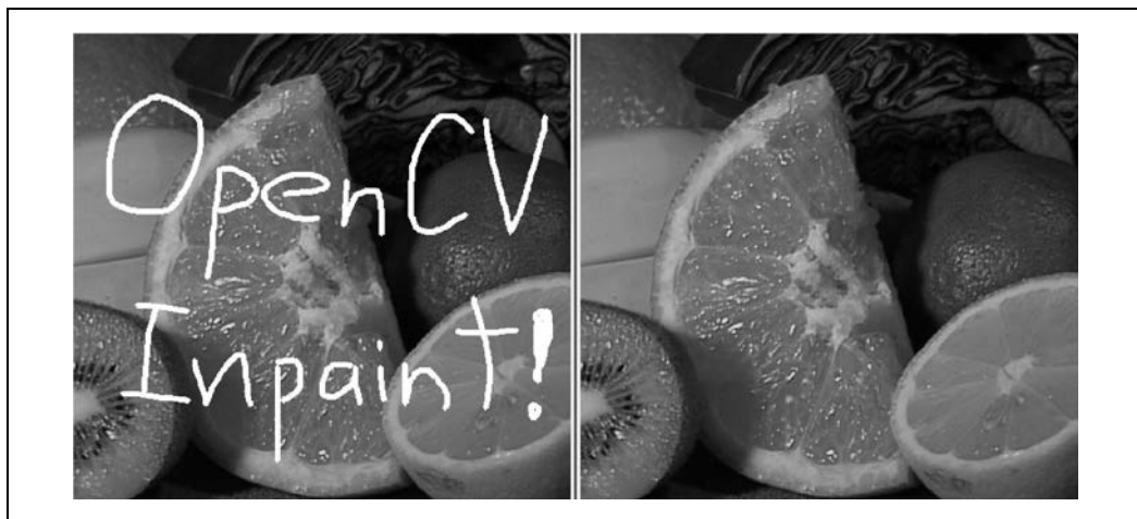
Rysunek 11.8. Po lewej: obraz zniszczony przez napis; po prawej: obraz wyretuszowany za pomocą techniki inpaintingu
