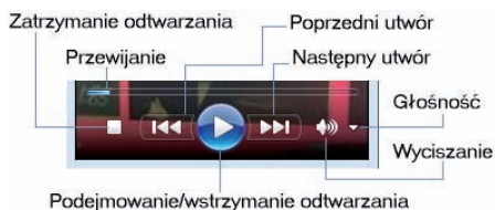
Rysunek 4.4. Funkcje przycisków obsługi odtwarzacza
