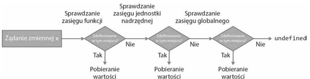
Rysunek 2.5. Tak wygląda kolejność interpretowania nazw w JavaScriptcie. Proces przebiega od zasięgu otaczającego zmienną do zewnątrz. Najpierw sprawdzany jest zasięg funkcji (lokalny), potem zasięg jednostki nadrzędnej (jeśli taka istnieje), a w ostatnim kroku zasięg globalny. Jeśli zmiennej x nie uda się znaleźć, funkcja zwraca wartość undefined
