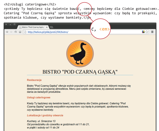
Rysunek 4.16. Kiedy zostanie pominięty ukośnik, przeglądarka nie wie, gdzie kończy się element, co ilustruje powyższy przykład
