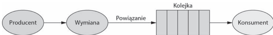
Rysunek 17.8. W AMQP producenci są odseparowani od kolejek przez wymianę, która zajmuje się kierowaniem komunikatów
