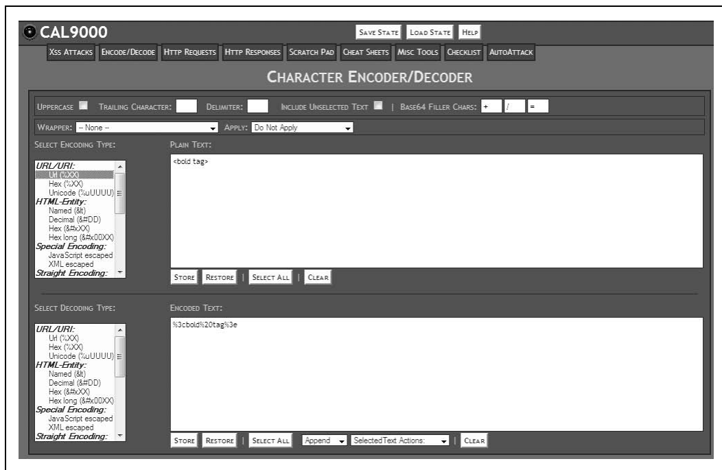
Rysunek 4.2. Kodowanie URL za pomocą narzędzia CAL9000
