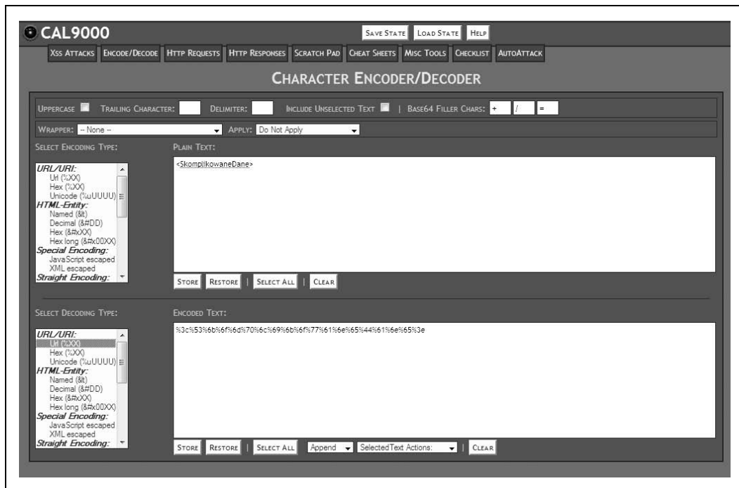
Rysunek 4.3. Dekodowanie danych zakodowanych w URL za pomocą narzędzia CAL9000
