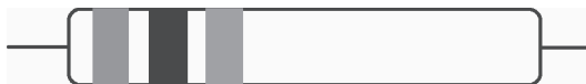
Rysunek 1.13. Na elemencie są trzy paski. Czerwony — liczba 2. Czarny — liczba 0. Zielony — mnożnik 10^5 . Brak czwartego paska — tolerancja 20%. Element ma wartość 2\text{ M}\Omega i tolerancję 20%
