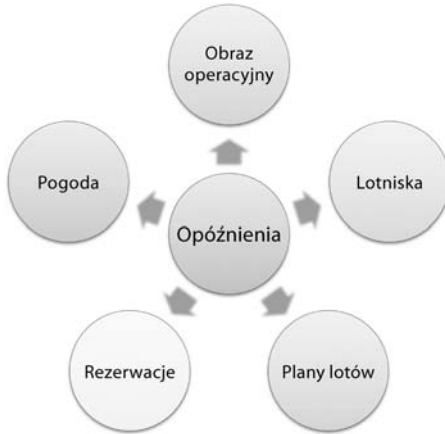
Rysunek 5.9. Niektóre z usług, z którymi musiałaby współpracować usługa „Opóźnienia”. Usługa „Opóźnienia” steruje kilkoma usługami bezpośrednio (takimi jak „Rezerwacje” i „Plany lotów”), ale sama jest sterowana danymi pochodzącymi z pozostałych usług („Pogoda”, „Obraz operacyjny” i „Lotniska”)
